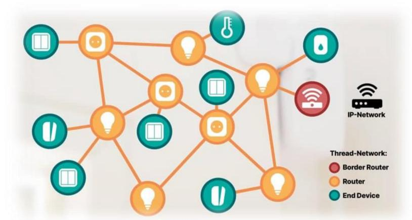
La struttura della rete con i nodi è simile a quella di Zigbee, ma mentre Zigbee assegna uno speciale indirizzo a 16 bit a ciascun nodo della rete, Thread funziona utilizzando direttamente il protocollo IPv6. In una rete Zigbee, l'indirizzo assegnato deve prima essere convertito in formato IP, solitamente da un gateway, il cosiddetto Zigbee Bridge.
