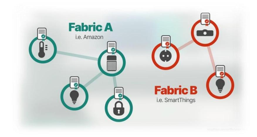
I nodi in «Fabric A» non possono essere raggiunti da «Fabric B» e viceversa. I nodi di un sistema non esistono per i controllori dell'altro sistema
