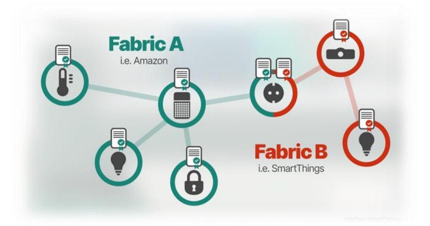
Ogni dispositivo installato può essere messo in modalità di accoppiamento da un controller del suo tessuto. Quindi reagisce allo stesso modo della prima messa in servizio e può ricevere un altro certificato di sicurezza da un nuovo ecosistema matter (min. 5)
